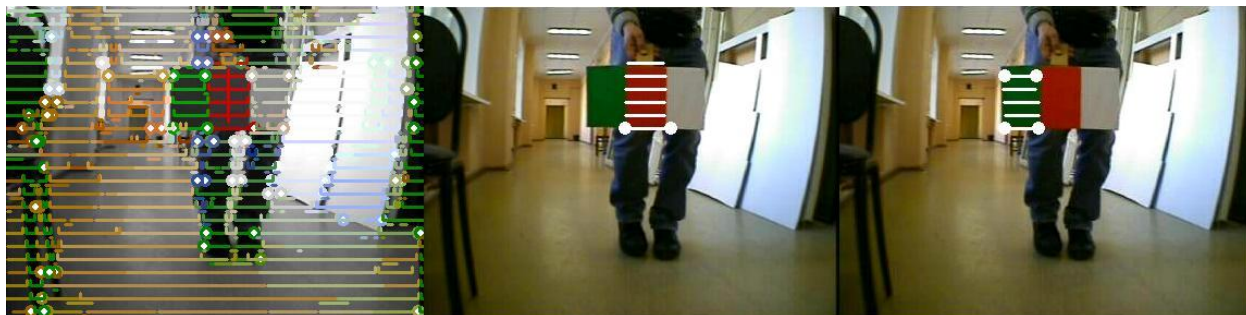
Рис. 1. Сегментация изображения, полученного с робота, и выделение составляющих метки
