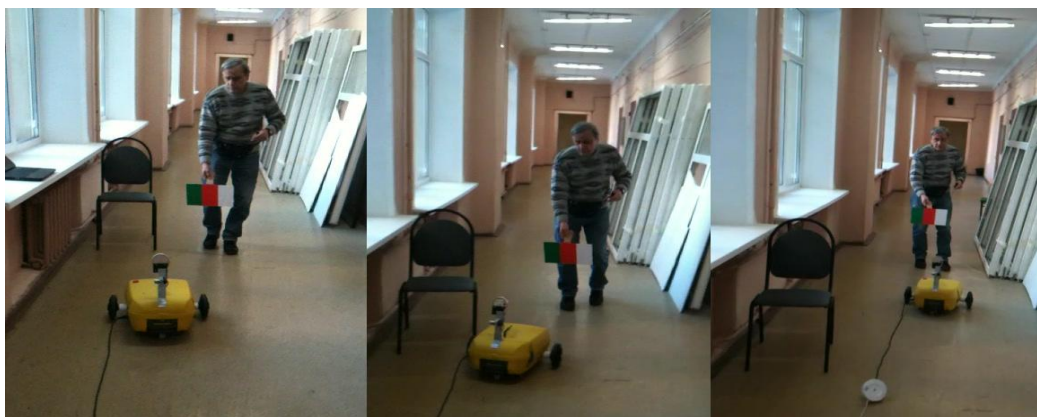
Рис. 2. Движение за меткой, кадры из видеопоследовательности
